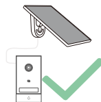
確保電源線自然放置且無拉力
